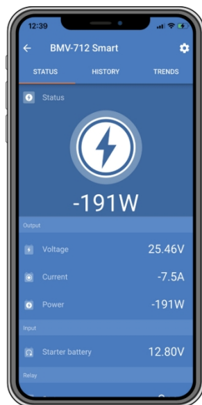
Stavová obrazovka aplikace VictronConnect monitoru baterií spuštěného v režimu monitoru stejnosměrného proudu.
