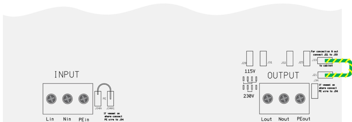
Propojení nulového vodiče (N) výstupu střídavého proudu se zemí (PE).
