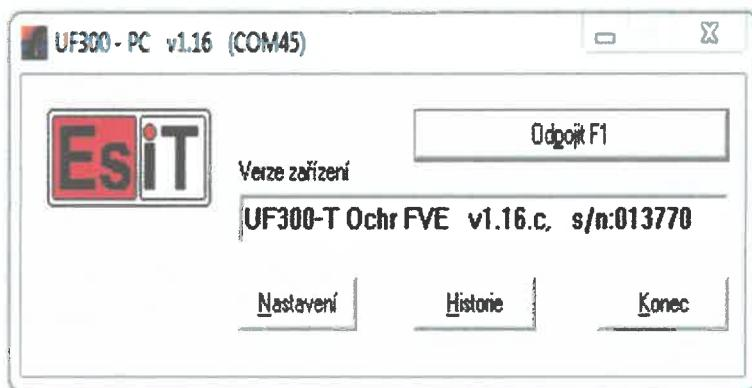
Klikněte na tlačítko *Připojit*. (horní dlouhé tlačítko – když je UF300 připojen, nápis tlačítka je „*Odpojit*“, když je UF300 odpojena, nápis na tlačítku je „*Připojit*“). Pokud je vše v pořádku, po připojení se vypíše název a verze firmwaru přístroje a dále i výrobního čísla přístroje. Vysvítí se tlačítka k obsluze a otevře okno s aktuálními hodnotami měřených veličin a stavu přístroje.
