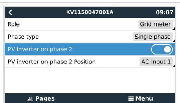
Jednofázová duální funkce pro měření sítě na L1 a fotovoltaického měniče na L2
